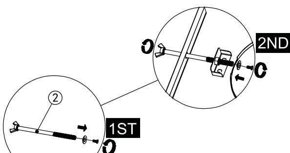
Utilizza la vite in dotazione (ove presente) per fissare la bombola
